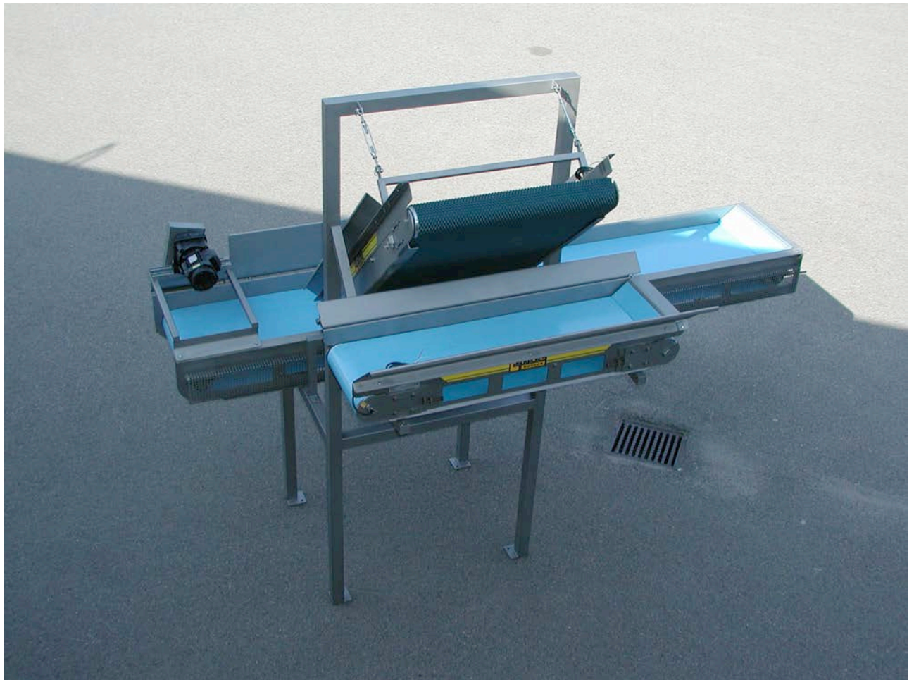
Diagonalställd transportör med små nabbar.
